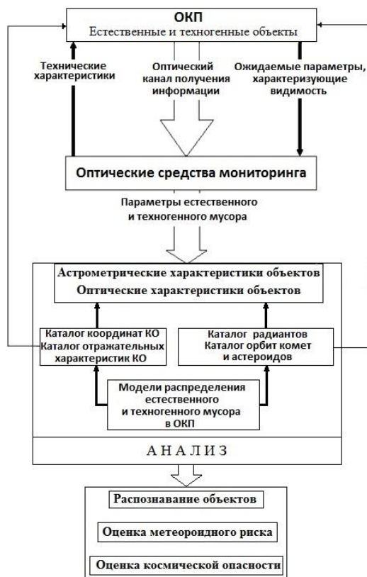
Рис. 1. Схема организации экспертной системы мониторинга объектов в ОКП оптическими средствами
