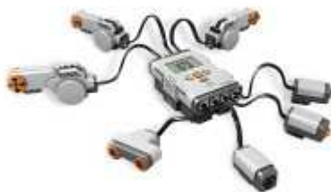
Рис. 1 – Микрокомпьютер, моторы и датчики серии NXT.
