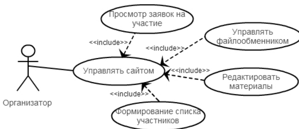
Рисунок 1 – Концептуальная модель электронного портала (UML-диаграмма вариантов использования)
