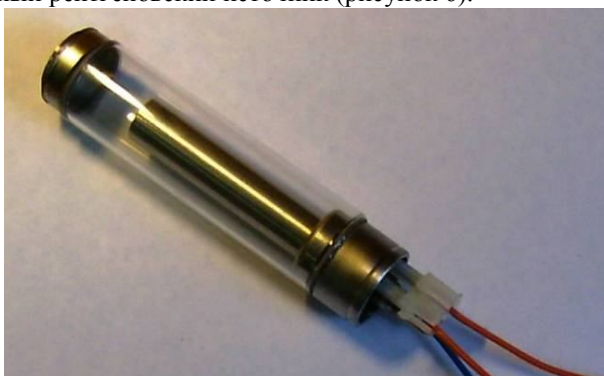
Рисунок 6 - Внешний вид вакуумированного базового макета рентгеновского источника.
