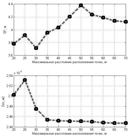
Рисунок 10 – Критерии эффективности сопоставления при варьировании максимального расстояния расположения точек на сканах
