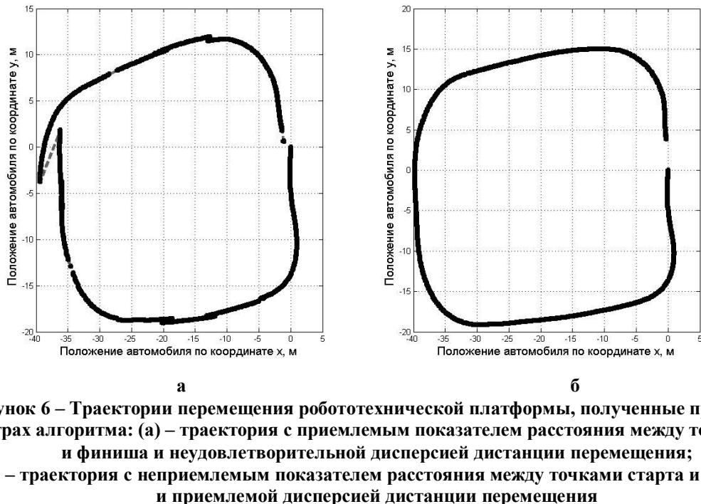
**Рисунок 6 – Траектории перемещения робототехнической платформы, полученные при разных параметрах алгоритма: (а) – траектория с приемлемым показателем расстояния между точками старта и финиша и неудовлетворительной дисперсией дистанции перемещения; (б) – траектория с неприемлемым показателем расстояния между точками старта и финиша и приемлемой дисперсией дистанции перемещения**
