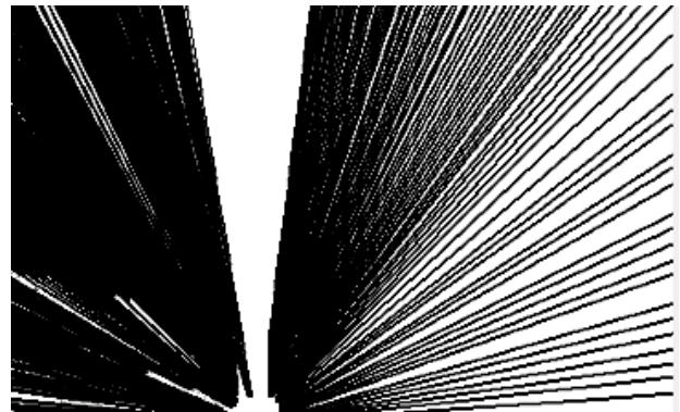
Рисунок 3 – Пример полученной карты проходимости на этапе экстраполяции хода сканирующего луча (чёрным цветом отмечены непроходимые участки, белым – проходимые)
