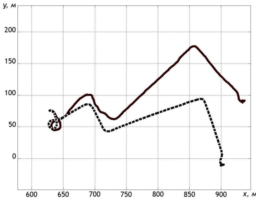
Рисунок 1 – Исходные GNSS данные и результат инерциальной навигации по энкодерам и гироскопу
