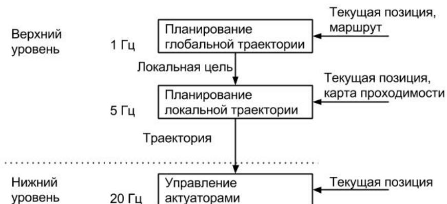
Рисунок 2 – Схема взаимодействия программных модулей планирования траектории и траекторного управления
