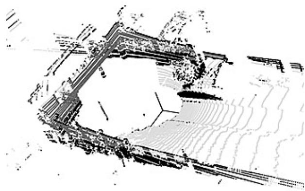
**Рисунок 7 – Выделение проходимых и непроходимых точек на скане с лидара (чёрным цветом показаны непроходимые точки, светло-серым – проходимые, тёмно-серым – непроходимые, но находящиеся выше габаритов транспортного средства)**
