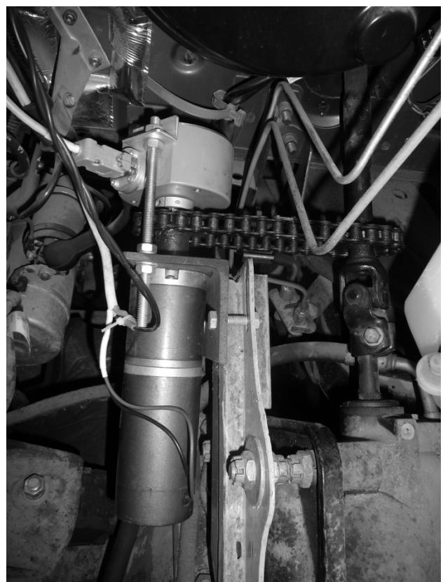
**Рисунок 8 – Устройство управления рулем**
