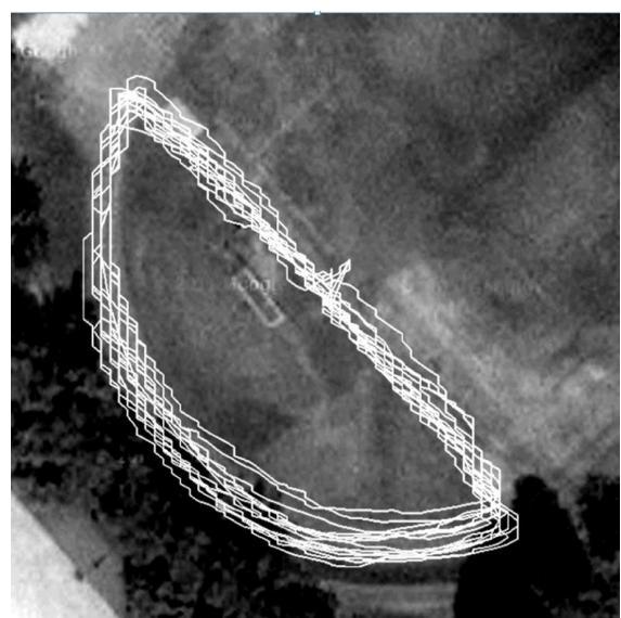
Рисунок 7 – Траектория по данным с одного модуля в первой фазе эксперимента
