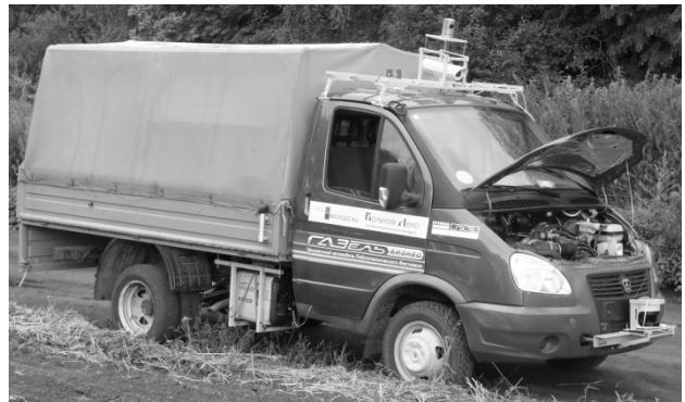
Рисунок 2 – Автомобиль-робот на базе «ГАЗель БИЗНЕС»
