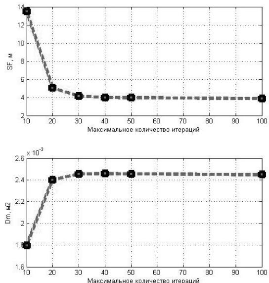
Рисунок 9 – Критерии эффективности сопоставления при варьировании максимального количества итераций алгоритма ICP
