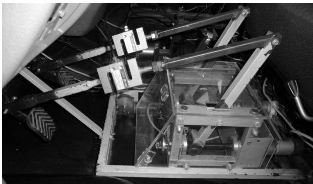
**Рисунок 7 – Устройство управления сцеплением, тормозом и акселератором**
