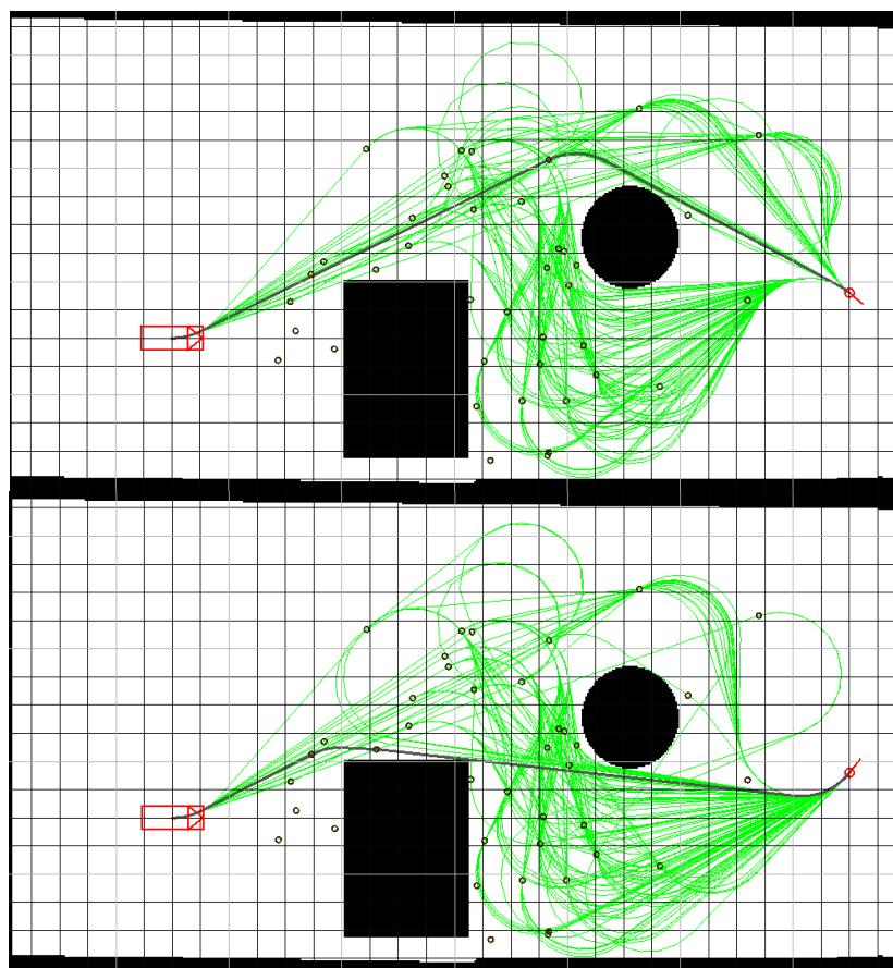
Рисунок 5 – Пример полученных траекторий (тонкая линия) и лучшая траектория (толстая линия). В зависимости от ориентации конечной позиции результирующая траектория проходит по-разному
