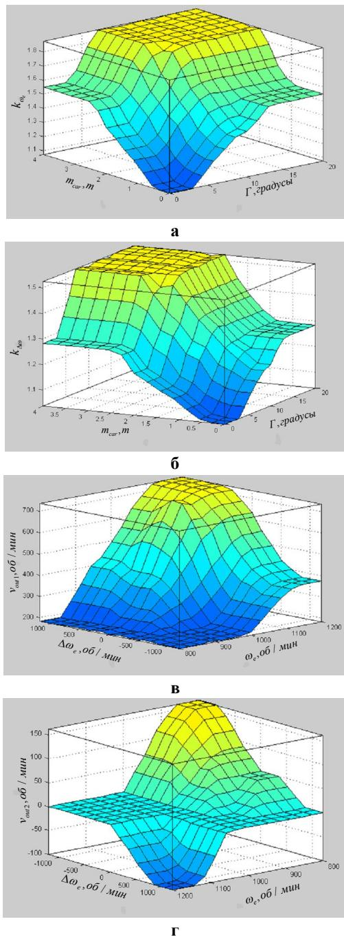
**Рисунок 10 – Графики поверхностей выходных функций нечётких регуляторов для различных углов наклона поверхности старта: а – коэффициент изменения области определения функции принадлежности для параметра  $\omega_e$ ; б – коэффициент изменения области определения функции принадлежности для параметра  $\Delta\omega_e$ ; в – угловая скорость вращения вала электромеханического привода педали сцепления; г – угловая скорость вращения вала электромеханического привода педали газа.**
