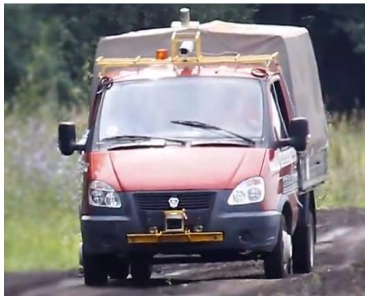
Рисунок 1 – Автомобиль-робот «ГАЗель»
