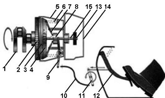
Рисунок 1 – Схема механического привода подключения сцепления: 1 – коленчатый вал; 2 – маховик; 3 – ведомый диск; 4 – нажимной диск; 5 – кожух сцепления; 6 – нажимные пружины; 7 – отжимные рычаги; 8 – подшипник выключения сцепления; 9 – вилка выключения сцепления; 10 – металлический трос; 11 – рычаг привода; 12 – педаль сцепления; 13 – шестерня первичного вала; 14 – катер КПП; 15 – первичный вал КПП
