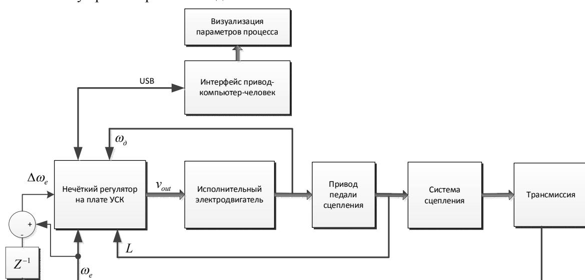
Рисунок 3 – Функциональная схема системы управления автомобилем без использования акселерации:  $\omega_e$  – угловая скорость вращения вала ДВС;  $\omega_o$  – угловая скорость вращения вала электромеханического привода педали сцепления;  $v_{out}$  – скорость вращения вала электромеханического привода педали сцепления;  $L$  – перемещение педали сцепления
