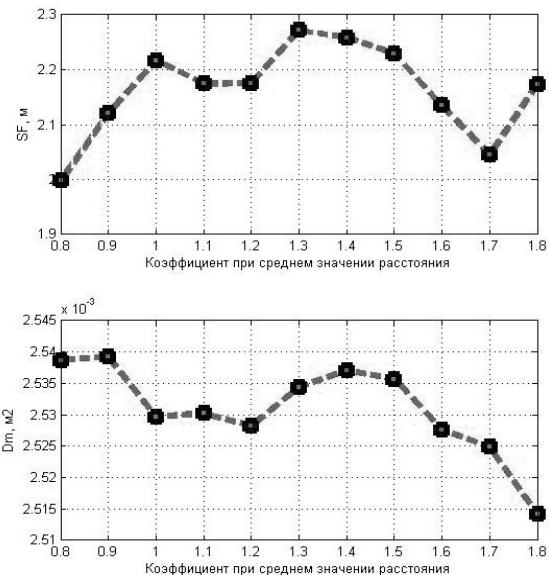
Рисунок 13 – Критерии эффективности сопоставления при варьировании коэффициента при среднем значении расстояния
