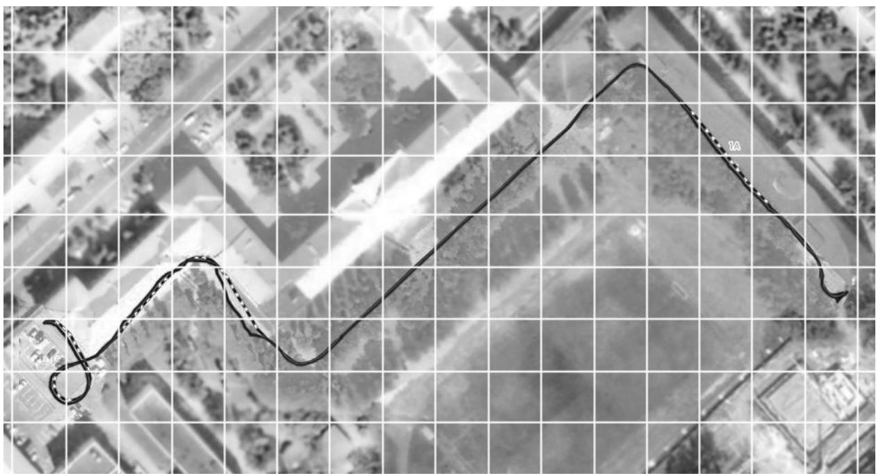
**Рисунок 2 – Результат оценки положения автомобиля-робота, отображённый на карте Google Maps: отфильтрованная траектория (пунктир) и исходные данные GNSS (сплошная), масштаб клетки 20 м**
