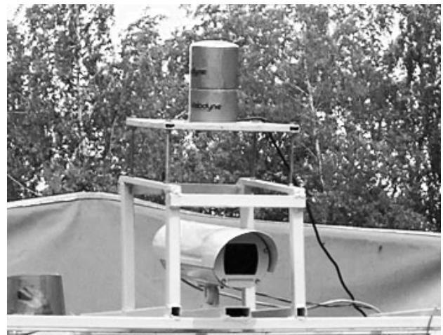
**Рисунок 6 – Лидар Velodyne HDL-32E и видеодатчик Beward BD3575, установленные на крыше автомобиля-робота «ГАЗель БИЗНЕС»**
