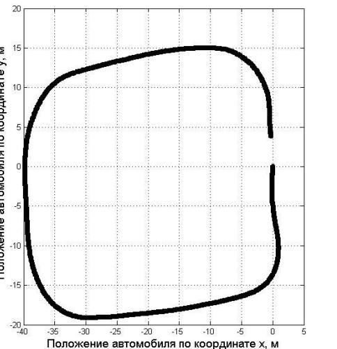
Основываясь на этом, будем считать, что скорость автомобиля в течение 1 с постоянна, при этом лидар совершает порядка 10 – 15 вращений с получением сканов. Усредняя значения изменения положения автомобиля на основе каждого 10 сканов (скользящее окно), мы можем найти разброс получаемых значений. Чем больше данный параметр, тем хуже сопоставление сканов.
