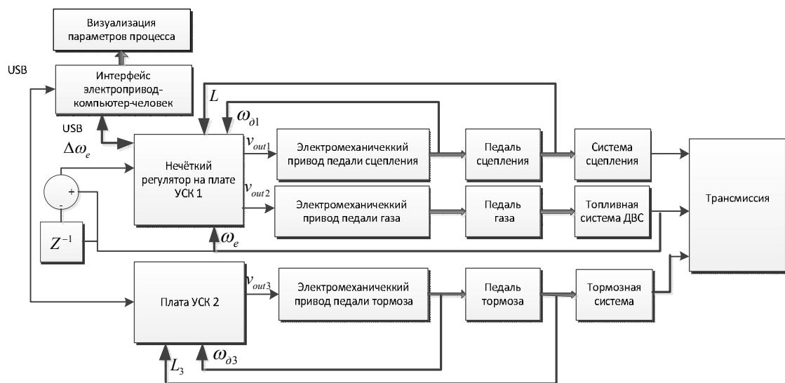
**Рисунок 5 – Функциональная схема системы управления автомобиля с использованием акселерации:**  $v_{out1}, v_{out2}, v_{out3}$  – скорости вращения валов электромеханических приводов педалей сцепления, газа и тормоза соответственно;  $\omega_e$  – угловая скорость вращения вала ДВС;  $\omega_{\dot{o}1}, \omega_{\dot{o}3}$  – угловые скорости вращения валов электромеханических приводов педалей сцепления и тормоза соответственно;  $L, L_3$  – перемещение педалей сцепления и тормоза
