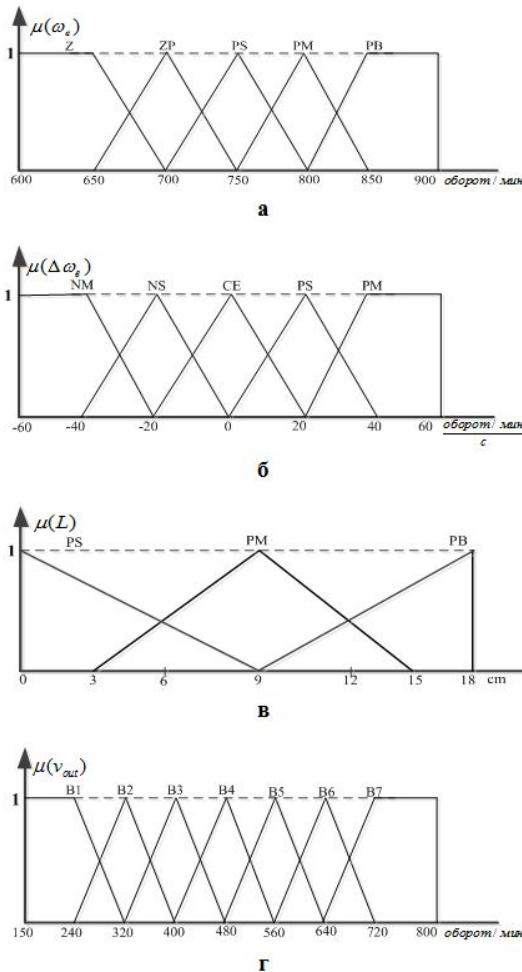
Рисунок 6 – Графики функции принадлежности для нечёткого регулятора управления сцеплением: а – входная переменная уставного значения угловой скорости вращения вала ДВС; б – входная переменная приращения угловой скорости вращения вала ДВС; в – входная переменная перемещения педали сцепления; г – выходная переменная угловой скорости исполнительного двигателя педали сцепления
