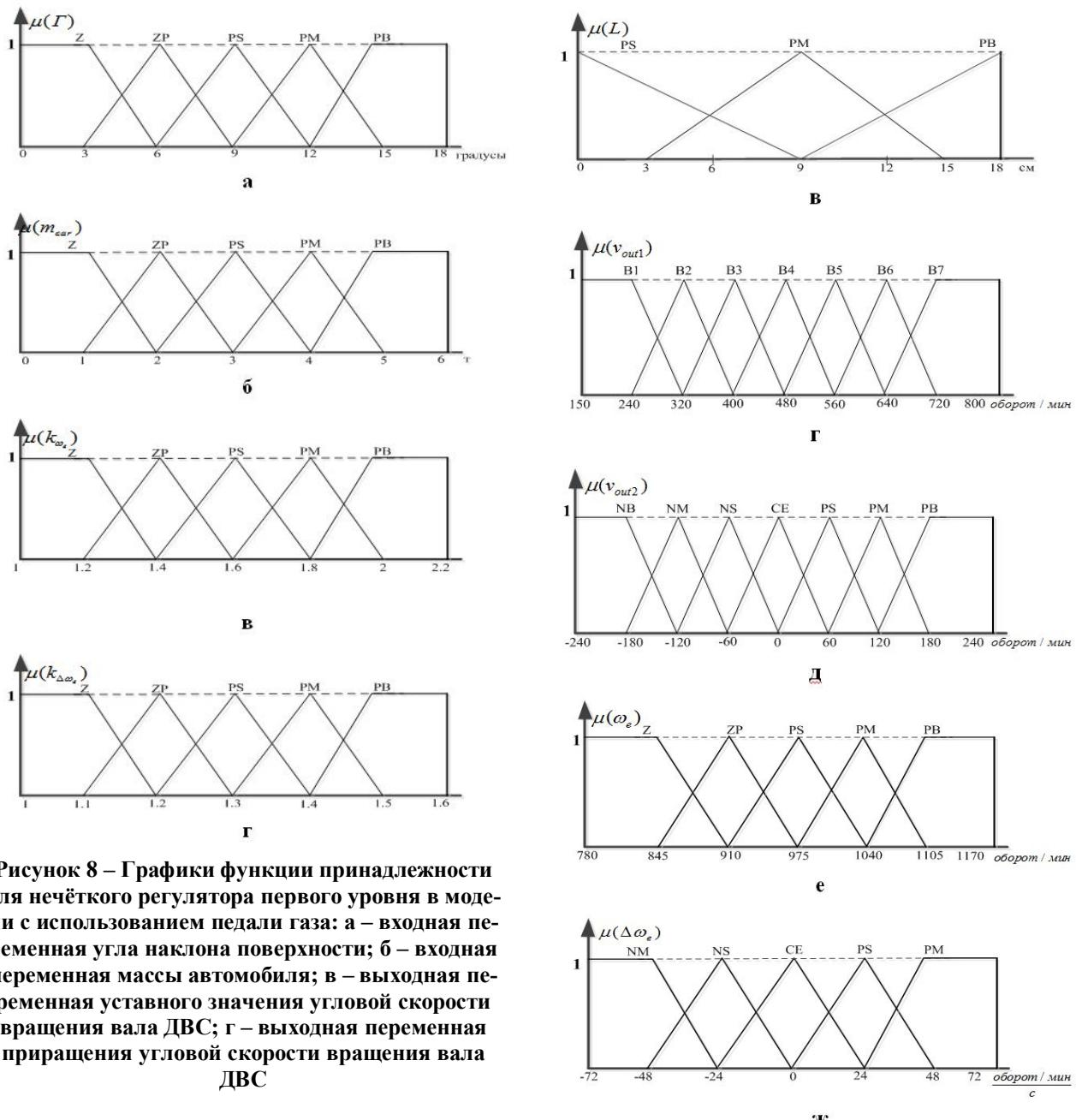
Рисунок 8 – Графики функции принадлежности для нечёткого регулятора первого уровня в модели с использованием педали газа: а – входная переменная угла наклона поверхности; б – входная переменная массы автомобиля; в – выходная переменная уставного значения угловой скорости вращения вала ДВС; г – выходная переменная приращения угловой скорости вращения вала ДВС
