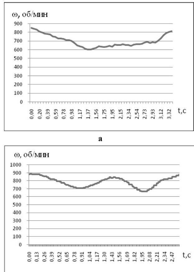
**Рисунок 11 – Графики изменения угловой скорости вращения вала ДВС при старте с ровной поверхности без использования педали газа:**
