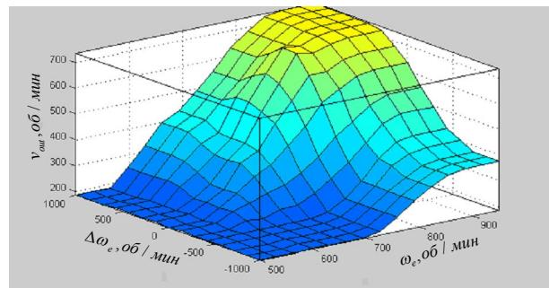
Рисунок 7 – График поверхности выходной функции нечёткого регулятора
