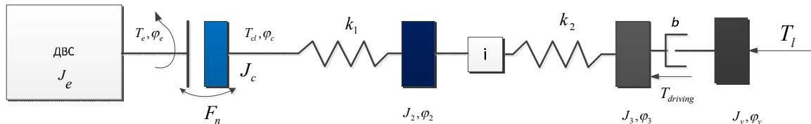
Рисунок 2 – Расчёчная динамическая модель трансмиссии автомобиля с фрикционным сцеплением
