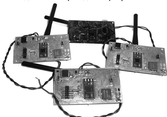
Рисунок 1 – Система сбора и коррекции данных спутниковых систем навигации
