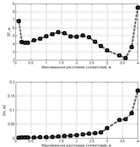
Рисунок 8 – Критерии эффективности сопоставления при варьировании максимального расстояния поиска соответствий алгоритма ICP
