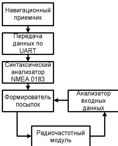
Рисунок 4 – Функциональная схема внешнего устройства
