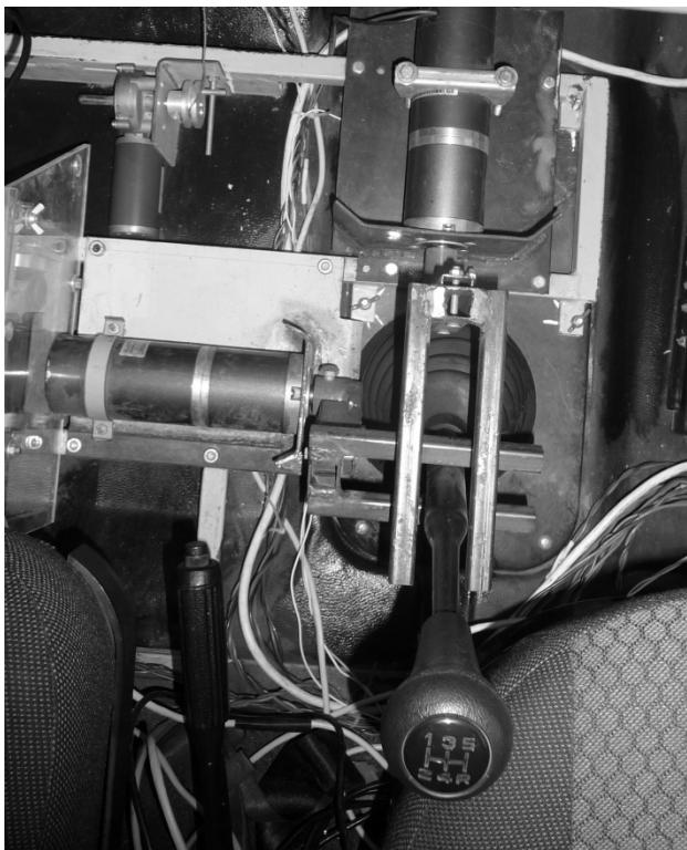
**Рисунок 6 – Устройство переключения передач**
