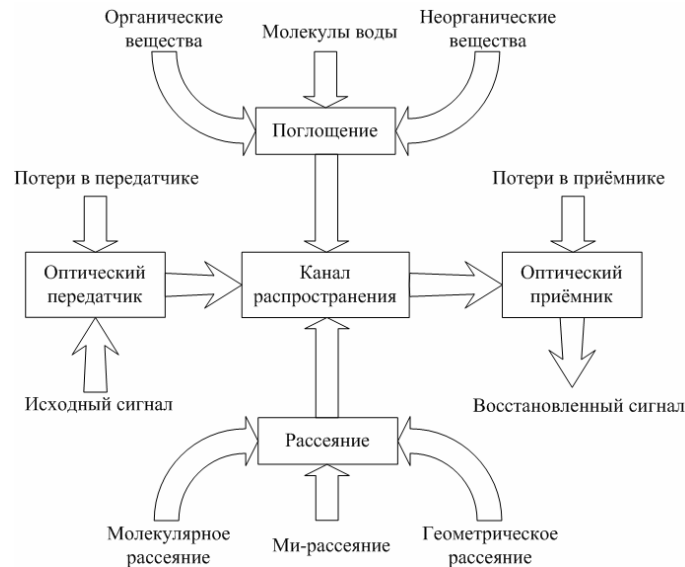
Рис.1. Схема распространения оптического сигнала в водной среде
