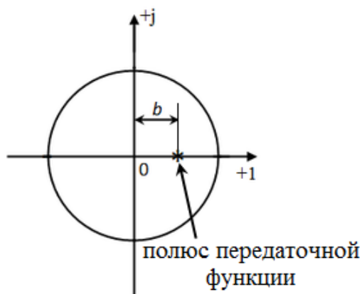
Рис. 2.22. Положение нулей и полюсов передаточной функции БИХ-фильтра 1-го порядка.
