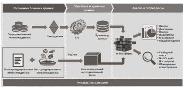
Рисунок 2 – Технологии обработки больших данных
