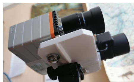
Рисунок 64 — Полунатурный макет МСТЗ: структурная схема (а), адаптер-переходник (б), закреплённый на штативе макет МСТЗ (в, г)
