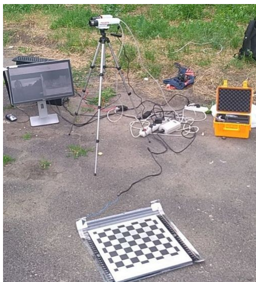
Рисунок 65 — Использованное в ходе полунатурного эксперимента оборудование: камеры на закреплённом на штативе адаптере, ПК, калибровочный тест-объект с шаблоном типа «шахматное поле»
