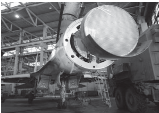
Рисунок 5 – РЛСУ «Ирбис-Э» на летающей лаборатории Су
