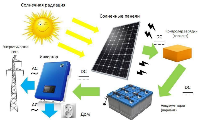
Рисунок 1 – принцип работы конструкции солнечной батареи
