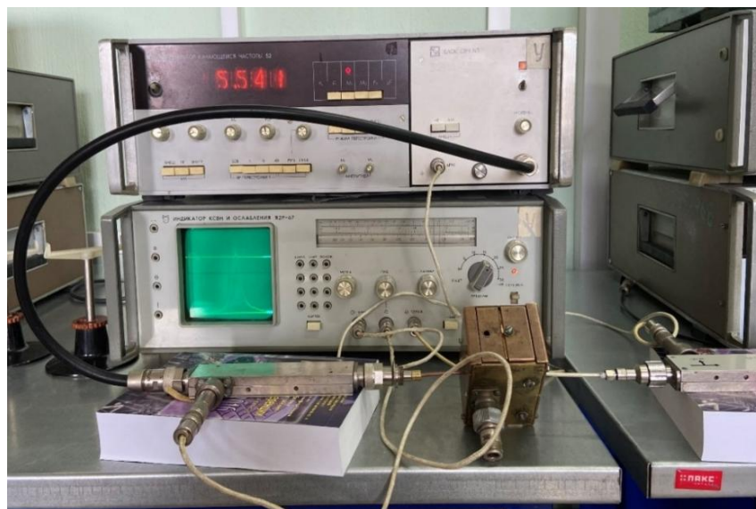
Рисунок 2.19 - Экспериментальная установка на базе измерителя КСВН и ослабления P2-56
