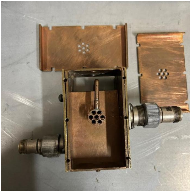
Рисунок 2.17 - Макет четырехзворного прямоугольного резонатора
