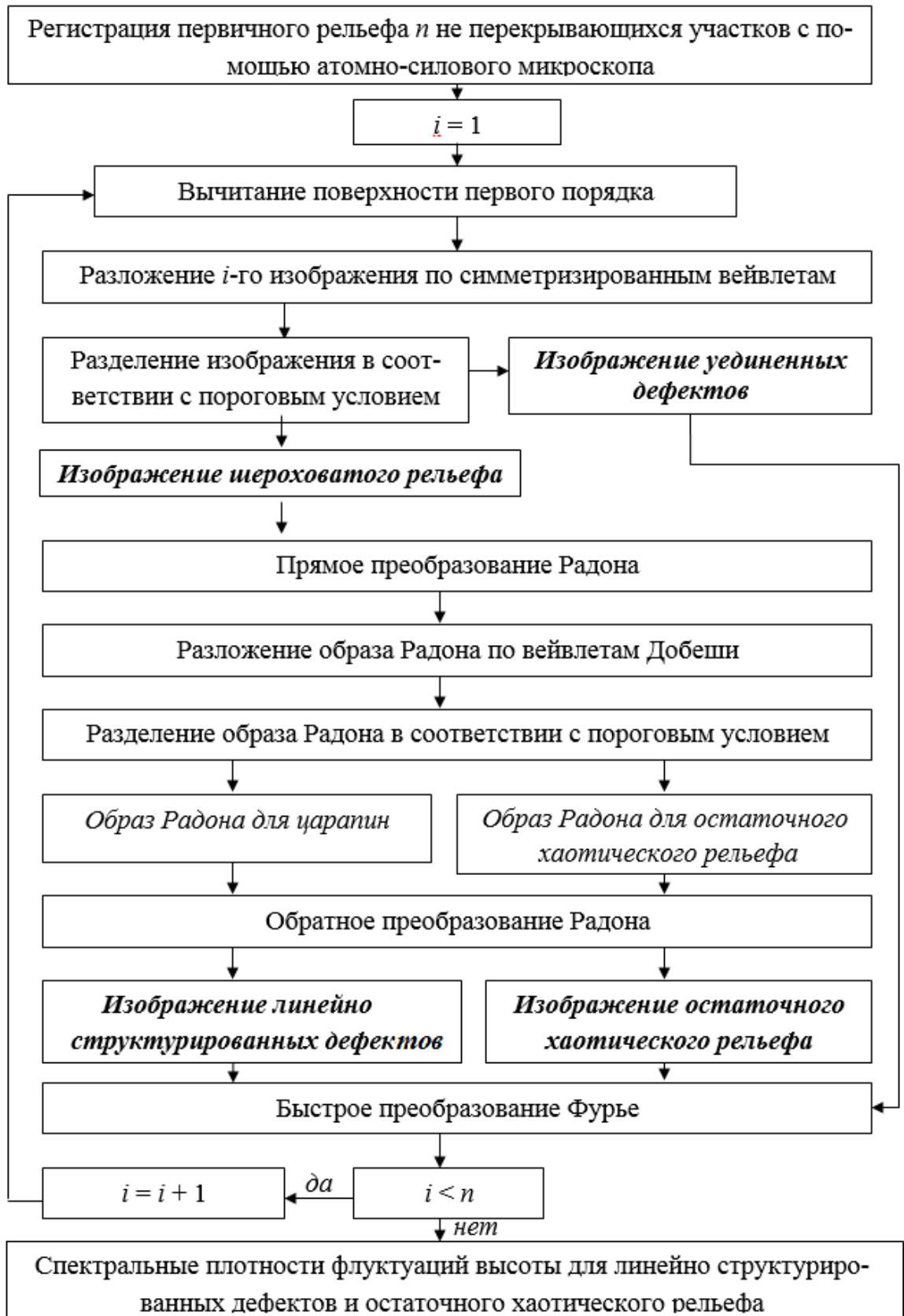
Рис. 3.23. Алгоритм обработки изображения оптической поверхности [72]
