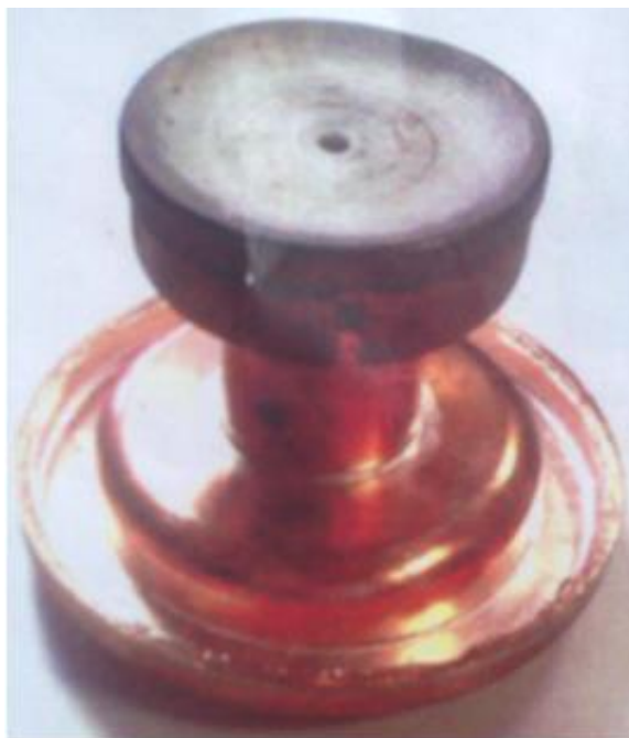
Рис.1.6. Изображение контакта чашеобразного типа
