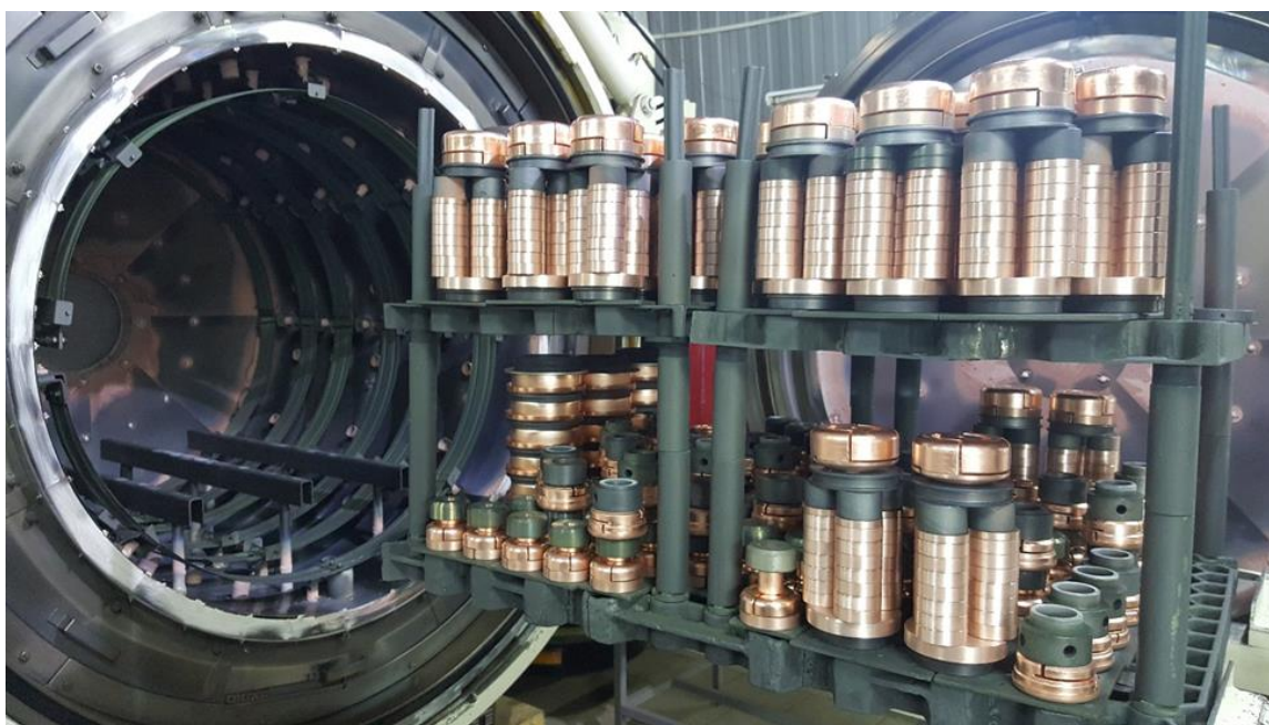
Рис. 2.28. Загрузка узлов приборов на пайку
