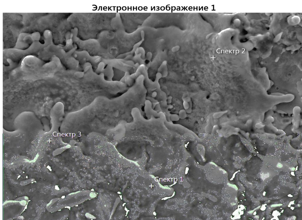
Рис. 3.29. Зона плавления и разбрызгивания вещества электрода
