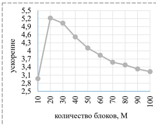
Рисунок 8 – Ускорение сортировки в зависимости от числа блоков из  $189 \cdot 10^6$  целых чисел на кластере Самарского университета (Intel Xeon, MPI, GPFS)
