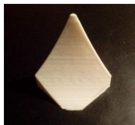
в Распечатанная поверхность z=(x+y)^2 с боковыми гранями
