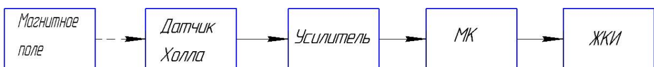
Рис. 2. Функциональная схема канала контроля параметров магнитного поля
