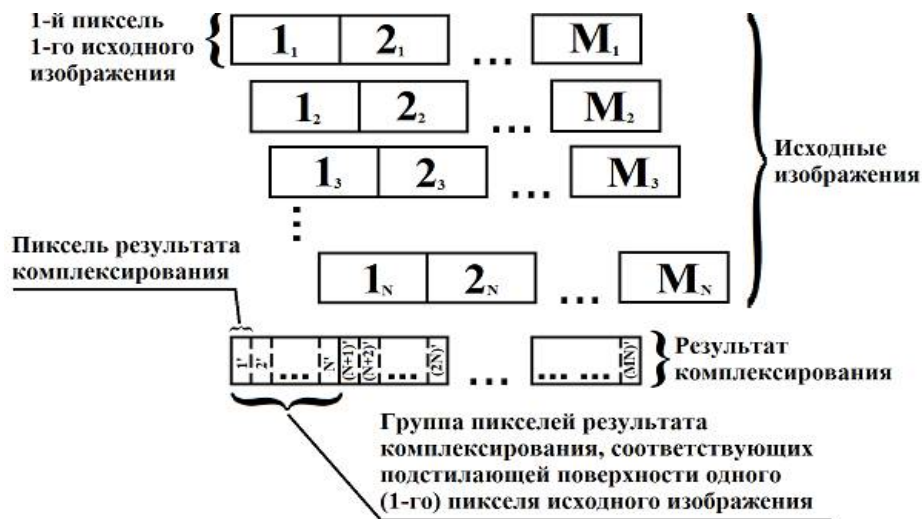
Рис. 1. Общая схема комплексирования субпиксельно смещенных изображений
