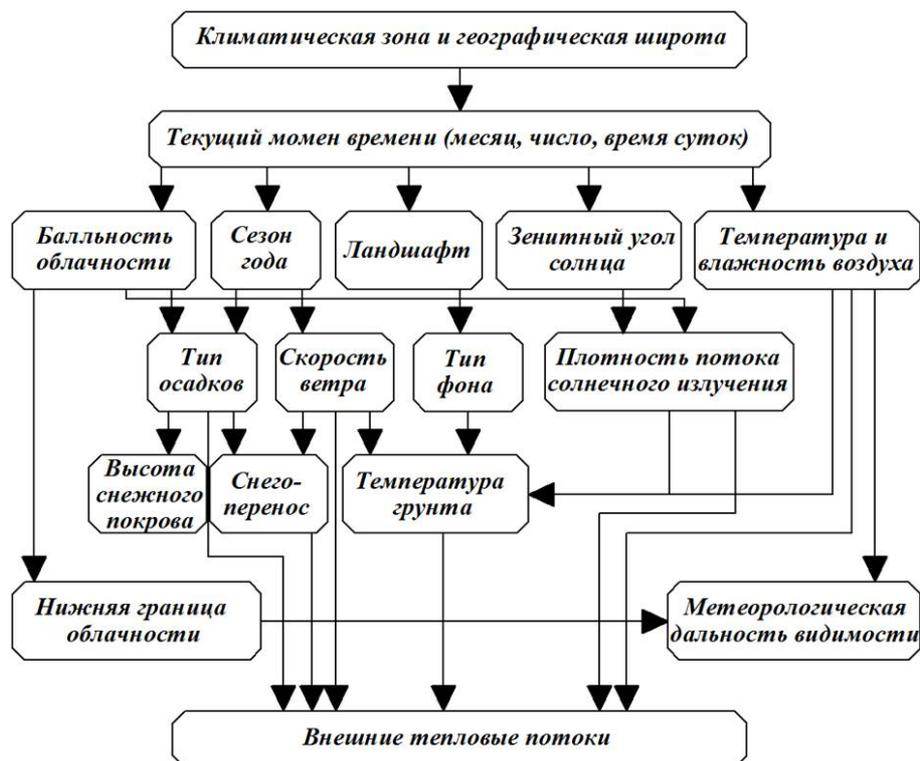
Рис. 1. Структура входных данных и определяемых атмосферно-климатических параметров
