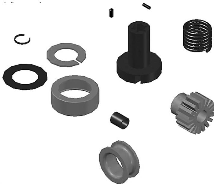
Рис. 1. Трехмерные электронные модели, входящие в сборочную единицу привода стартера
