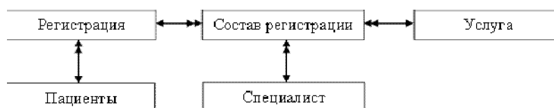
Рис. 2. Диаграмма «сущность-связь» после преобразования
