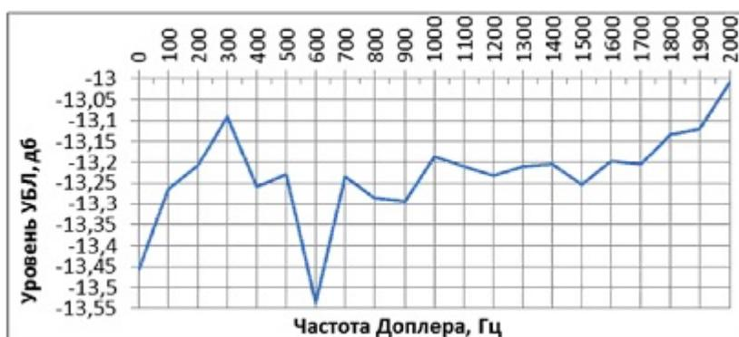
Рис. 9. Зависимость уровня УБЛ от частоты Доплера
