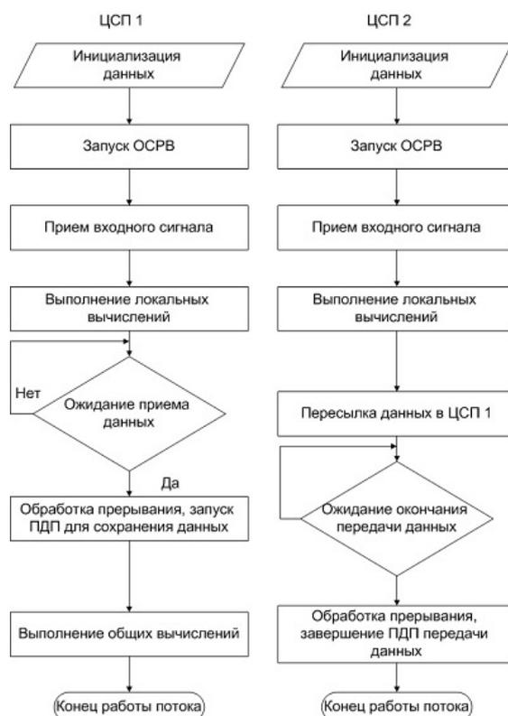
Рис. 2. Иллюстрация алгоритма параллельной обработки радиолокационной информации
