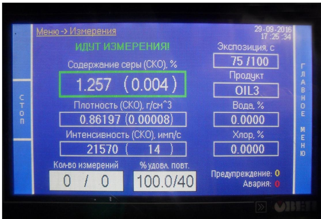
Рис.4. Пример вывода на экран оператора результатов, полученных с помощью поточного анализатора на потоке нефти
